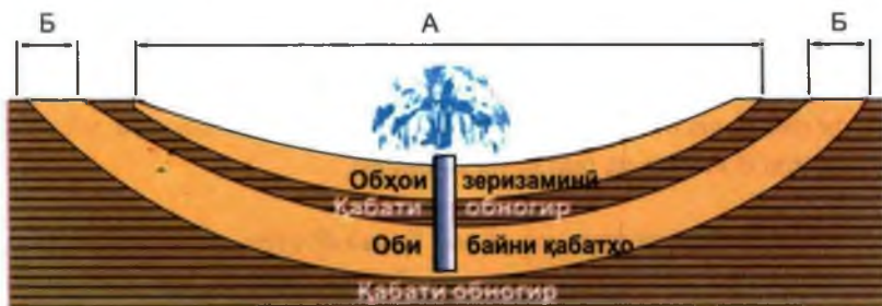
54. Оби байни қабатҳо. Манбаъҳои он: А - оби зеризаминӣ; Б - оби байни қабатҳо
